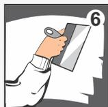
**6** Шпатлевку БОЛАРС «Гипсовая» нанесите стальным шпателем на основание слоем от 0,2 до 5 мм. Для получения более толстого слоя допускается шпатлевание в несколько слоев. Последующий слой нанесите после полного высыхания предыдущего, предварительно прогрунтовав поверхность грунтующими составами БОЛАРС.
